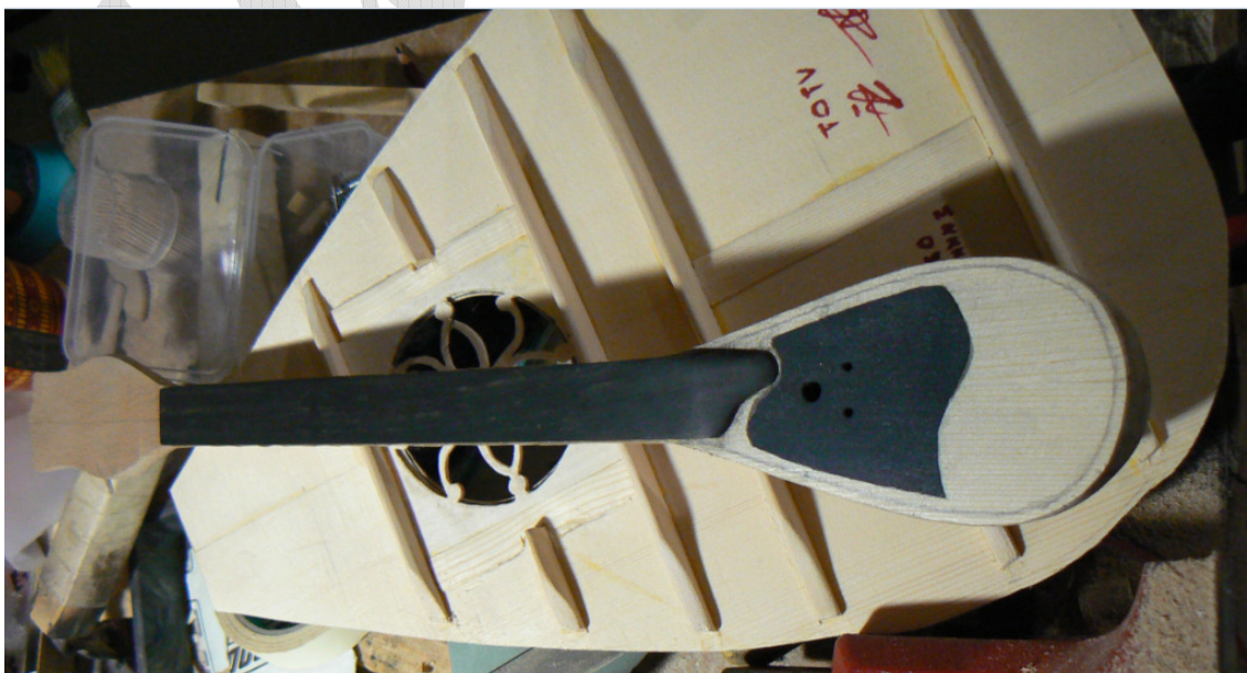
Φωτογραφία 4: Οπλισμός καπακιού
